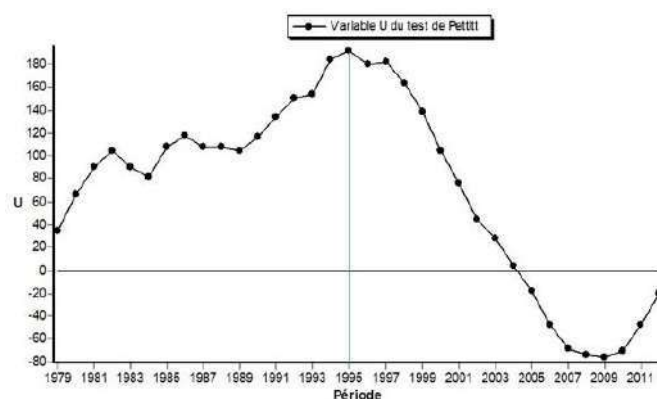
Fig. 5: Evolution de la variable U du Test de rupture de Pettitt pour la série de pluies annuelles dans le bassin de Sankarani.
